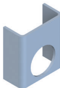
SUPORTE U FIXAÇÃO DO PÉ MECÂNICO SP737 - Antigo 135 mm ch. 6,35 mm - 1,220 kg SP737A - Moderno 185 mm ch. 6,35 mm - 1,770 kg
