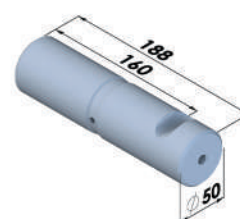
PINO DA BALANÇA TRUCK/CAVALO Ø 50x190 mm SP488 - Temperado SP488A - Sem Têmpera
