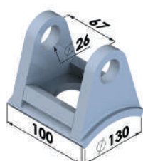
APOIO TENSOR P/EIXO REDONDO Ø 130 mm SUSPENSÃO CARREGA-TUDO SP989
