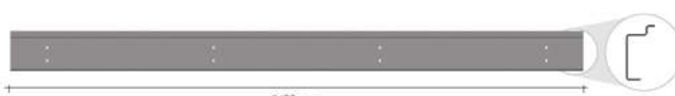
PERFIL TRASEIRO DA CARRETA PARA ASSOALHO DE FERRO - 2430mm SP390 - ch. 4,25mm - 24,300kg
