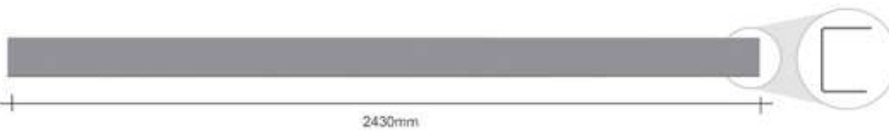
PERFIL TRASEIRO LINHA HORIZON - 2430mm SP523 - ch. 4,25mm - 22,000kg
