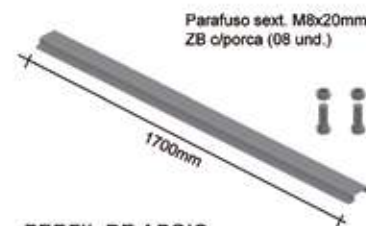
PERFIL DE APOIO DO PNEU - 1700mm SP805.2 - ch. 4,25mm - 9,310kg
