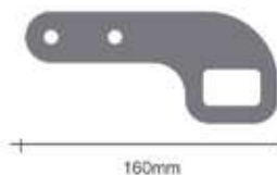
ENGATE FÊMEA DA TAMP SUPERIOR/INFERIOR 160mm SP761 - ch. 6,35mm - 0,290kg *SEM PINTURA (10 unidades)
