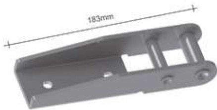
DOBRADIÇA DA TAMP - 183mm SP513 - ch. 4,25mm - 0,560kg SP513B - *SEM PINTURA (25 unidades)
