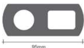
ENGATE FÊMEA LINHA R - 95mm SP308 - ch. 6,35mm - 0,120kg * SEM PINTURA (25 unidades)
