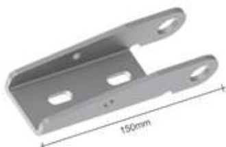
DOBRADIÇA DO TOMBADOR INFERIOR MODERNA - 150mm SP366 - ch. 4,25mm - 0,370kg SP366B - SEM PINTURA (10 unidades)
