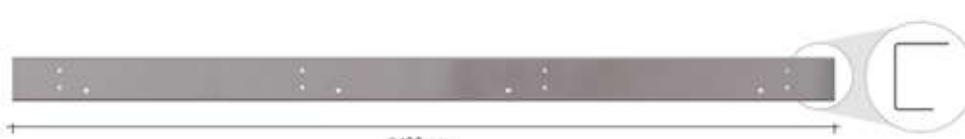
PERFIL TRASEIRO DA CARRETA COM FURAÇÃO LN R 2019 - 2430mm SP778 - ch. 4,25mm - 23,330kg
